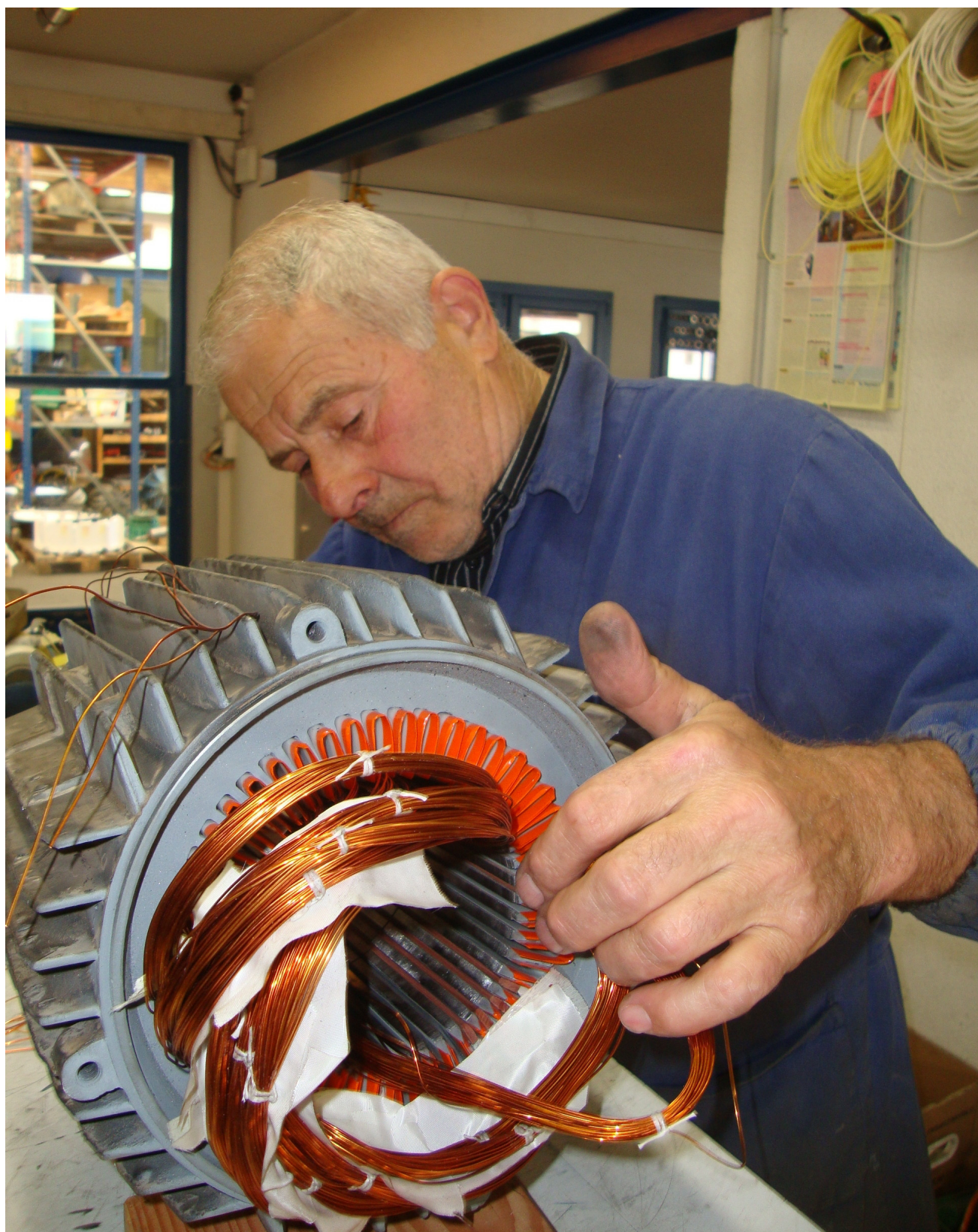
Nello-Piero Amaducci bewickelt einen Motor bei der Werder Elektromaschinen AG in Turgi. ANDREAS BANNWART
